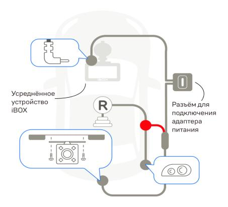
Проложите шнур камеры в салоне автомобиля и подключите его в разъём на совместимом устройстве. Подключите адаптер питания, идущий в комплекте с устройством, в разъём на кабеле КЗВ. Красный провод шнура соедините с проводом в автомобиле, на котором появляется напряжение +12 В при включении передачи заднего хода (например, к фонарю заднего хода автомобиля).
